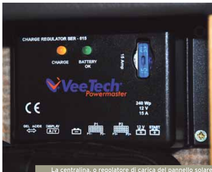
La centralina, o regolatore di carica del pannello solare
