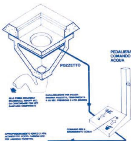
Colonnina per l'erogazione dell'acqua potabile e pozzetto autopulente per lo scarico delle acque chiare e luride.
