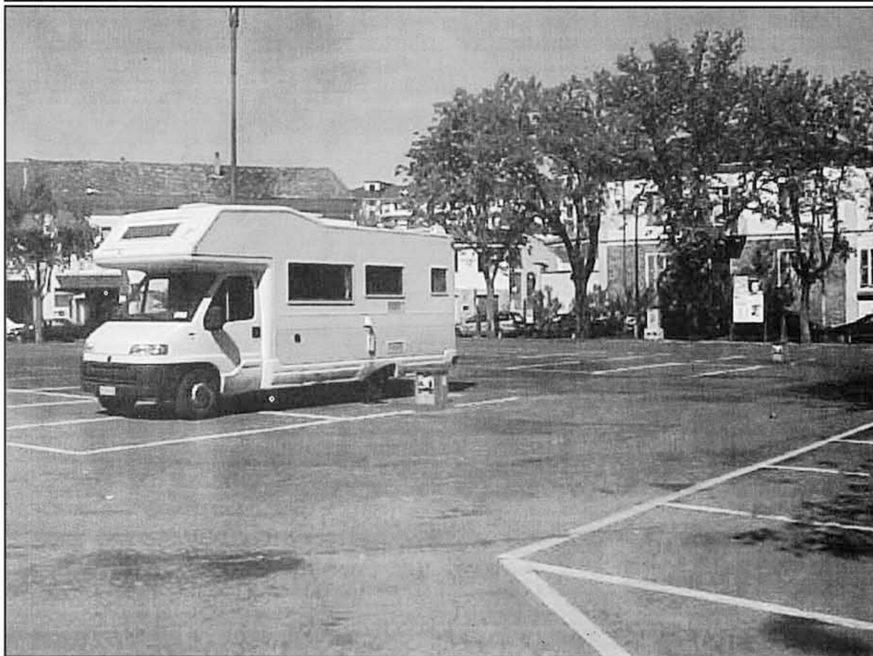
Vista della Piazza con autocaravan allacciato alla colonnina a scomparsa (erogazione forza motrice)
