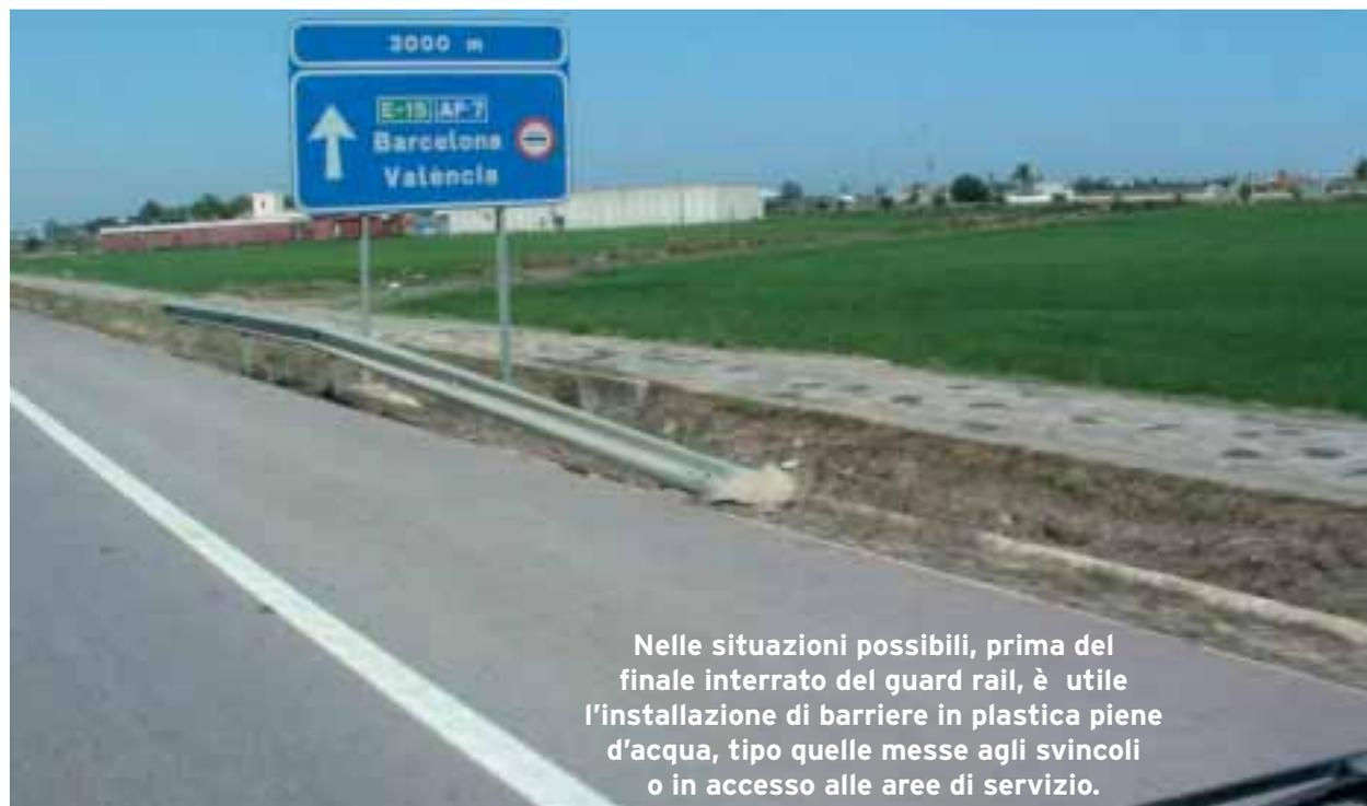
Nelle situazioni possibili, prima del finale interrato del guard rail, è utile l'installazione di barriere in plastica piene d'acqua, tipo quelle messe agli svincoli o in accesso alle aree di servizio.
